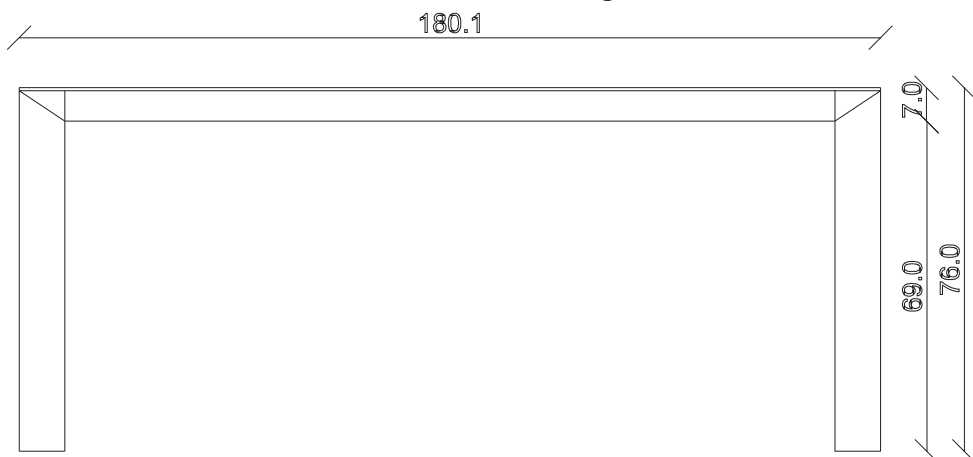
TAVOLO VISTA FRONTALE LATO LUNGO front view of the long side of the table
